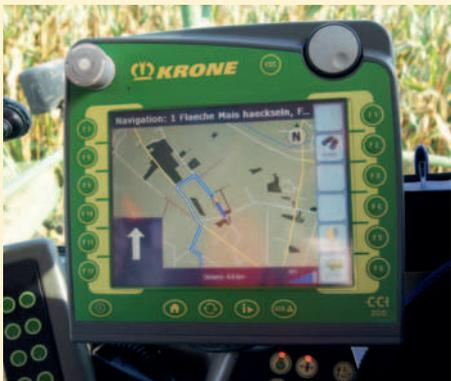
■ *FieldNav (Fa. Lacos) ermöglicht die komfortable Navigation zum Schlag.*
